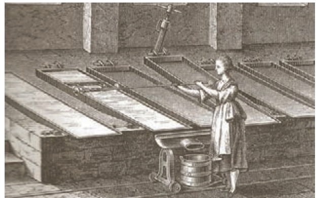
Beim holsteinischen Aufräumungsverfahren wurde die Milch ohne vorheriges Kühlbad bei 12-15°C für 24-36 Std. aufgestellt und abgerahmt.
